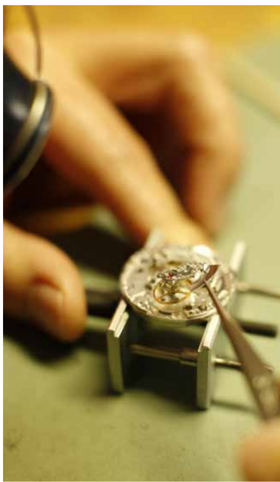
Filigrane Handarbeit: Das Einsetzen einer Uhr in das eingespannte Uhrwerk mithilfe einer Pinzette erfordert viel Ruhe und Geduld.
